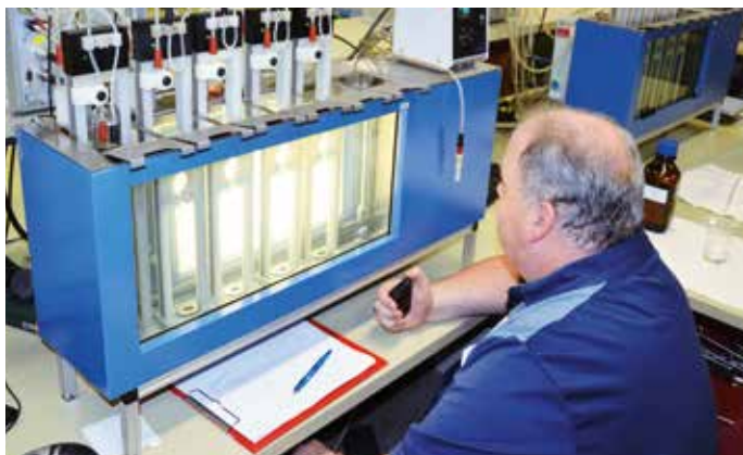
Mit der Kalibrierung bekommen die Viskosimeter eine ID-Nummer sowie ein Zertifikat, aus dem die spezifischen Eigenschaften hervorgehen.
