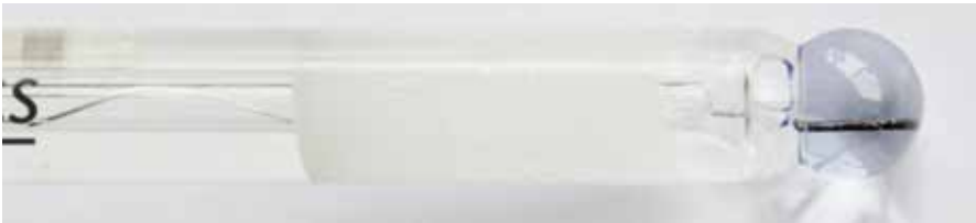
③ Blaue pH-Glaskugel an der Spitze einer pH-Elektrode.
