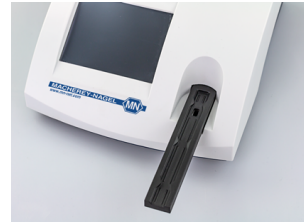
Abb. 18: Ausrichtung der Kerben prüfen
