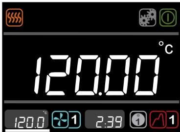
Drehen Sie den Regler, bis das Symbol für die Solltemperatur aufleuchtet. Drücken Sie zum Auswählen die Taste **S**. Stellen Sie die Solltemperatur mit dem Regler ein. Drücken Sie zum Bestätigen der Einstellung die Taste **S**.
