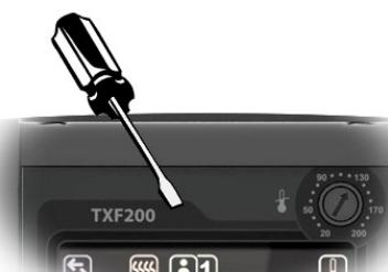
Stellen Sie mit dem Regler die Temperatur ein, bei der die Übertemperaturabschaltung aktiviert werden soll (höher als die Solltemperatur).
