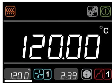
Ruotare la manopola fino ad evidenziare l'icona dell'impostazione della temperatura. Premere il pulsante **S** per selezionare. Ruotare la manopola per impostare la temperatura desiderata. Premere il pulsante **S** per impostare.
