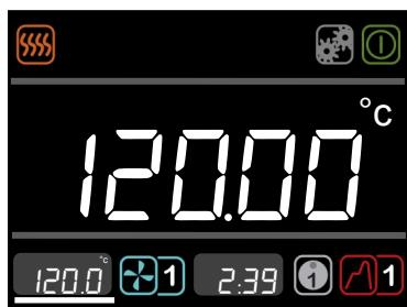
Gire el mando hasta que el ícono de ajuste de temperatura quede resaltado. Pulse el botón **S** para realizar la selección. Gire el mando hasta la temperatura deseada. Pulse **S** para realizar el ajuste.
