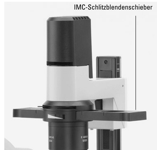
Kondensoreinstellung bei kippbarem Durchlicht-Beleuchtungsarm - Schlitzblende einstellen
