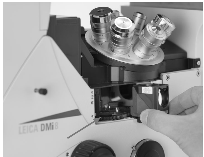
Leerposition zur Aufnahme eines Filterwürfels. Der Filterwürfel wird gerade von vorne eingeschoben bis er einrastet.
