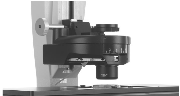
Kondensoreinstellung bei kippbarem Durchlicht-Beleuchtungsarm - Dunkelfeldstopp (Lichtring) einstellen
