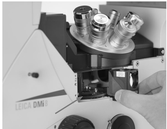
Position vide pour logement d'un cube de filtres. Le cube de filtres est introduit de face jusqu'à l'enclenchement.
