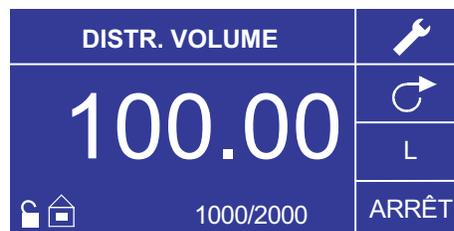
Figure 3-11. Fonctionnement du Mode distribution de volume
