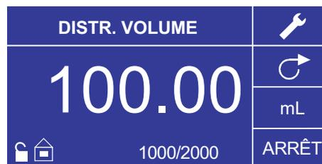
1. **Pour commencer** : Dans le Menu principal, utiliser la touche ENTRÉE pour sélectionner le Mode distribution de volume afin d'obtenir l'écran de fonctionnement du Mode distribution de volume.
