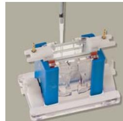
6) Una vez fijado el gel, transfíralo al tanque y llene los compartimientos interno y externo de tampón.
