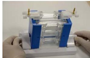
5) Vierta el gel resolutivo y permita que se fije. Luego añada la solución del gel apelmazador (*stacking*) y coloque el peine.
