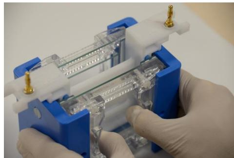
4. Positionieren Sie PAGE-Gel-Insert auf einer ebenen Fläche. **PAGE-Gel-Insert nicht in die Gieß-Basis an dieser Stelle stecken.**
